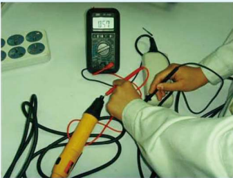
接地电阻 连接轴到3pAC连接线电源插头接地线铜片之间 0.57Ω-----OK
