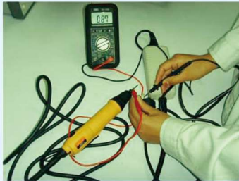
接地电阻 起子头到3pAC连接线电源插头接地线铜片之间 0.87Ω-----OK
